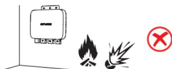
Die Schutzklasse des Mikrowechselrichters ist IP 67, so dass er sowohl im Innen- als auch im Außenbereich installiert werden kann. Die tragbare EcoFlow Powerstation ist jedoch nicht wasserdicht. Wenn Ihr System eine tragbare Powerstation enthält, sollten Sie diese in geschlossenen Räumen aufbewahren.
